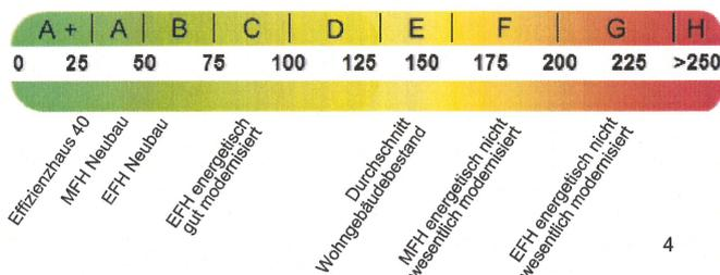
Die modellhaft ermittelten Vergleichswerte beziehen sich auf Gebäude, in denen die Wärme für Heizung und Warmwasser durch Heizkessel im Gebäude bereitgestellt wird. Soll ein Energieverbrauch eines mit Fern- oder Nahwärme beheizten Gebäudes verglichen werden, ist zu beachten, dass hier normalerweise ein um 15 bis 30 % geringerer Energieverbrauch als bei vergleichbaren Gebäuden mit Kesselheizung zu erwarten ist.
